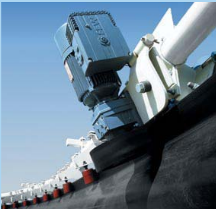
SEW Movimot op een bulktransportband, die op meerdere punten wordt aangedreven. De aandrijvingen worden aangestuurd via een veldbus
