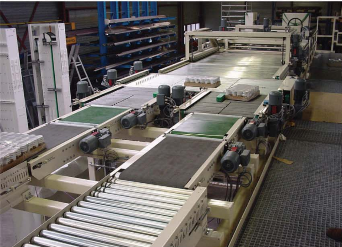
Palletiseerinstallatie voor trays met champignons, met een capaciteit van max. 6.000 trays/uur. Deze volautomatische installatie wordt aangedreven en bestuurd met SEW-aandrijvingen.
