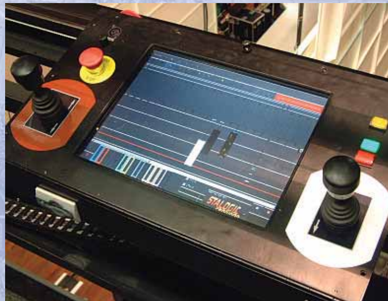
De bediening gebeurt vanaf geautoriseerde bedieningsunits en de bediener heeft altijd zicht op datgene wat hij of zij moet aansturen. De bedieningshendels functioneren als een soort dodemansknop
