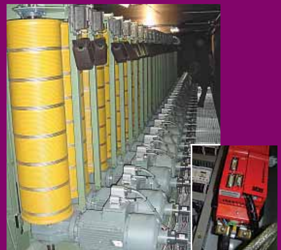
Bij deze liertrommelaandrijvingen (links) (overigens niet in Carré, maar wel gelijkwaardig) zijn de dubbele encoders duidelijk te zien, met de Movidrive Compact-regelaar (rechts) wordt de snelheid van de lier geregeld (foto's: Vector)
