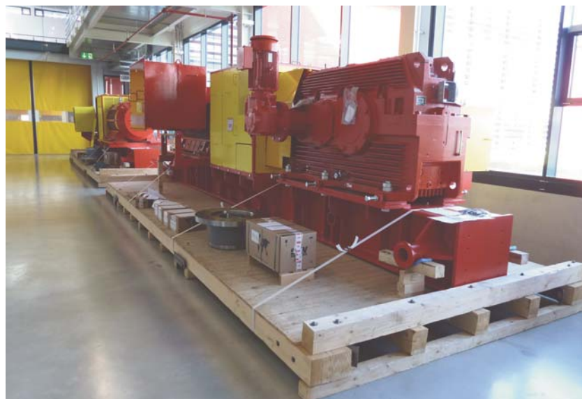
Complete tandwielkasten staan gereed voor verzending, inclusief ter plekke te monteren onderdelen, reservedelen en alle documentatie. Van buitenaf toegankelijke draaiende dus potentieel gevaarlijke delen worden standaard geel gespoten
